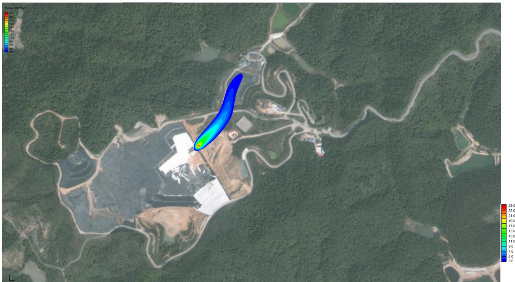
图 6.2-22 淋溶液调节池池底泄漏后 20 年，潜水含水层中 COD 污染晕
