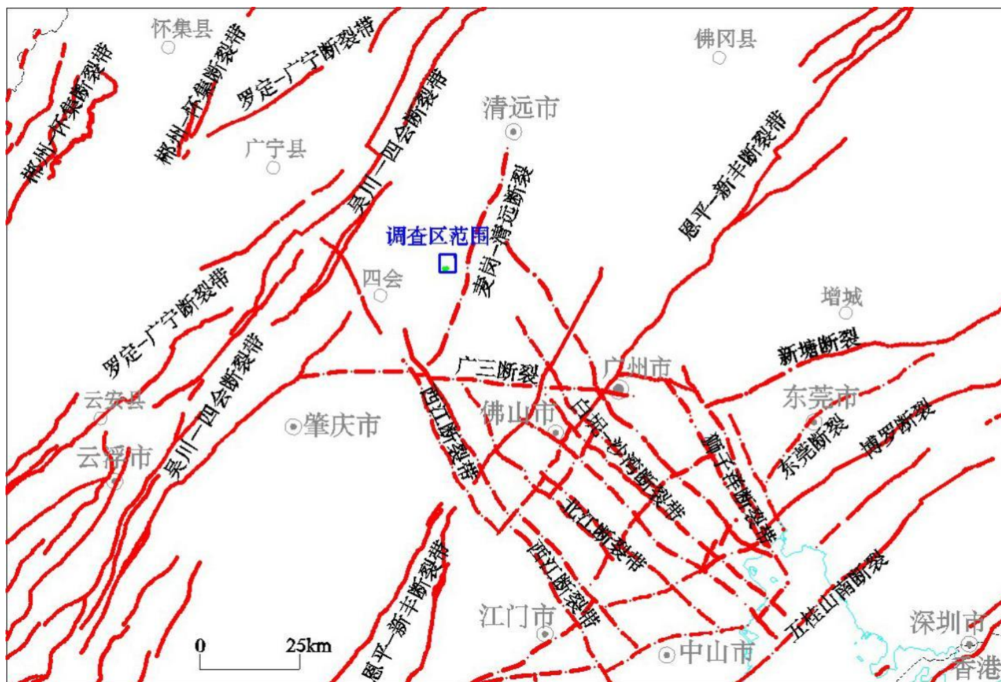
图 6.2-1 调查区及外围主干断裂平面展布图
