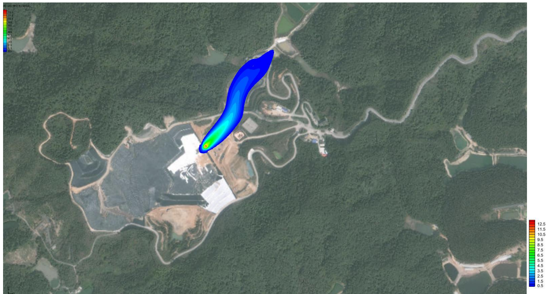
图 6.2-27 淋溶液调节池池底泄漏后 20 年，潜水含水层中氨氮污染晕
