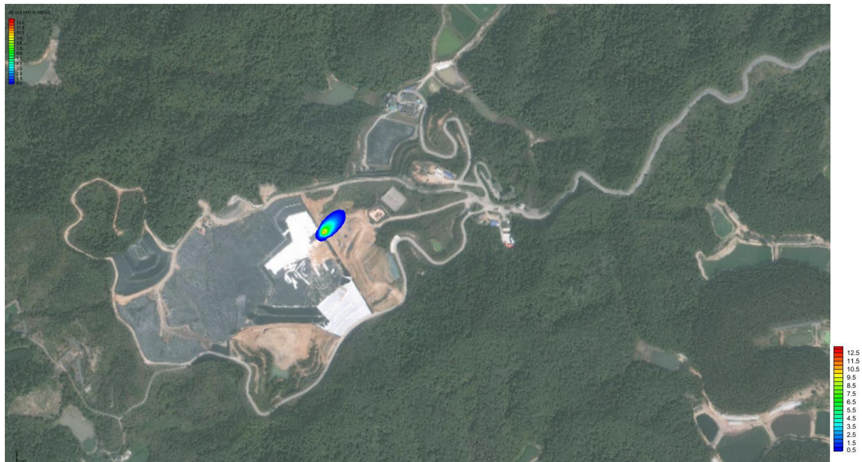
图 6.2-25 淋溶液调节池池底泄漏后 1000 天，潜水含水层中氨氮污染晕
