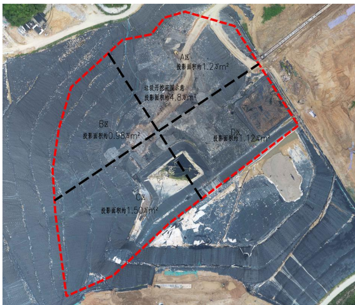
图 4.3-11 卫星图上开挖范围及分区示意
