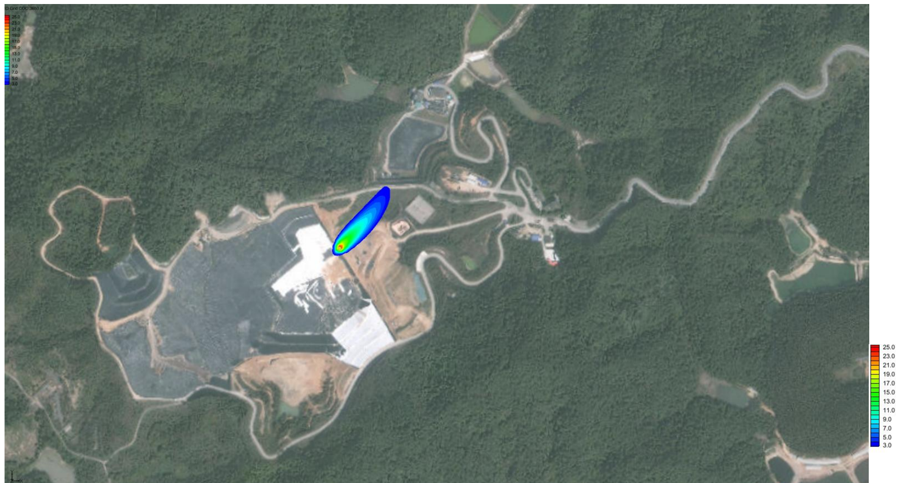
图 6.2-21 淋溶液调节池池底泄漏后 10 年，潜水含水层中 COD 污染晕
