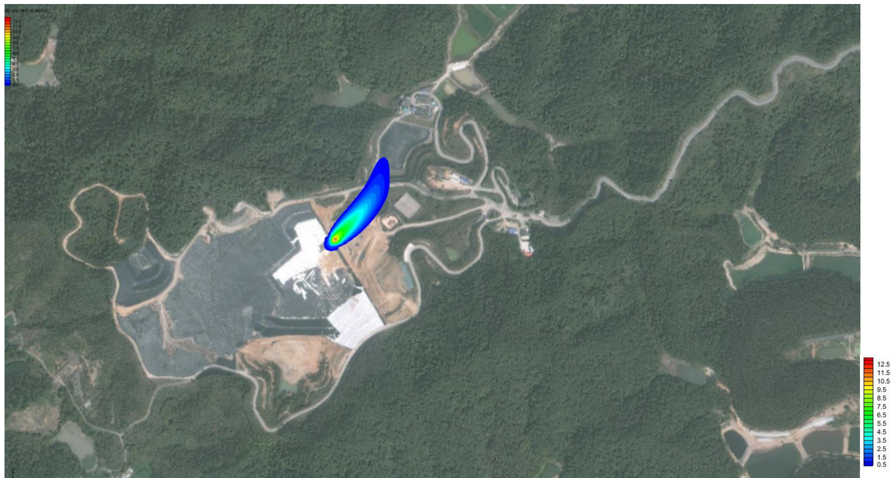
图 6.2-26 淋溶液调节池池底泄漏后 10 年，潜水含水层中氨氮污染晕
