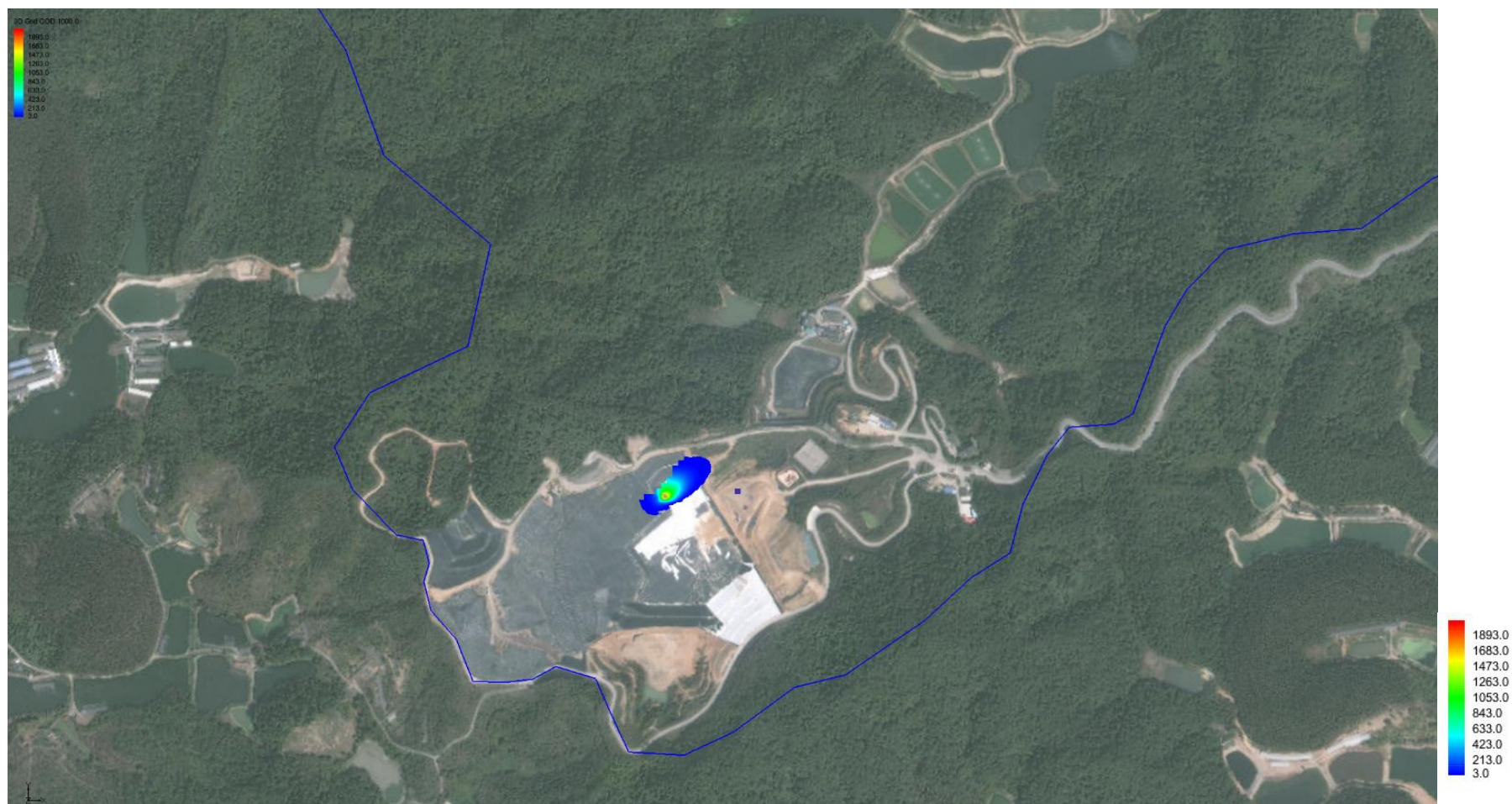
图 6.2-36 应急填埋区破裂泄漏后 100 天，潜水含水层中 COD 污染晕
